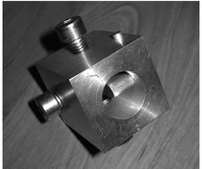
Ryc. 1. Specjalnie zaprojektowany uchwyt, w którym mocowano ząb z przyklejonym zamkiem.
