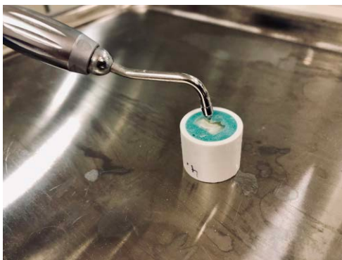
Ryc. 5. Piaskowanie powierzchni zęba proszkiem Sylc Fig. 5. Sandblasting tooth surface with the Sylc powder
