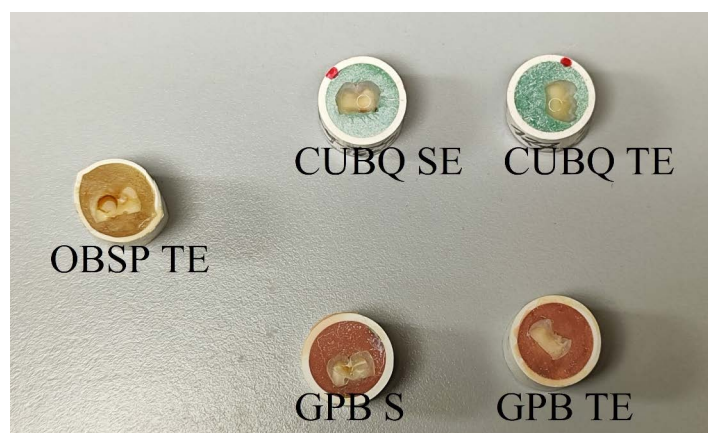
Ryc. 2. Przykładowy wygląd próbek zębiny po badaniu wytrzymałości na ścinanie technologiczne łączonych z wykorzystaniem różnych samotrąwiających systemów wiążących
